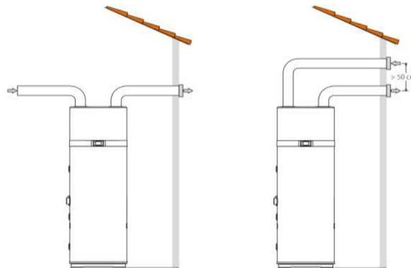
Luftansaugung aus dem Aufstellraum: Hierbei ist eine geeignete Belüftung im Aufstellungsraum des Geräts zu beachten.
