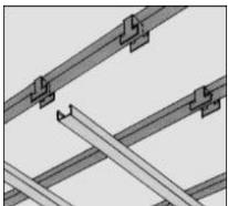
Die Tragprofile werden mit den Schienenverbindern verbunden und mit Richtscheit und Wasserwaage feinjustiert. Anschließend kann die vorgesehene Dämmung eingelegt werden.
