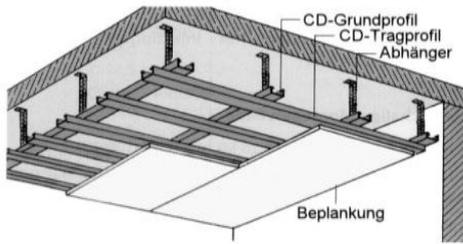
Bei Unterdecken wird die Unterkonstruktion nicht direkt, sondern über Abhänger an der Rohdecke befestigt. Das Abstandsmaß zwischen Rohdecke und Unterkante Unterdecke ist abhängig von der Art der Abhänger und der Unterkonstruktion, der Nutzung des Deckenhohlraumes (Installationen, Dämmung) und der geplanten lichten Raumhöhe.
