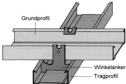
Unterdecken mit abgehängter Metallunterkonstruktion
