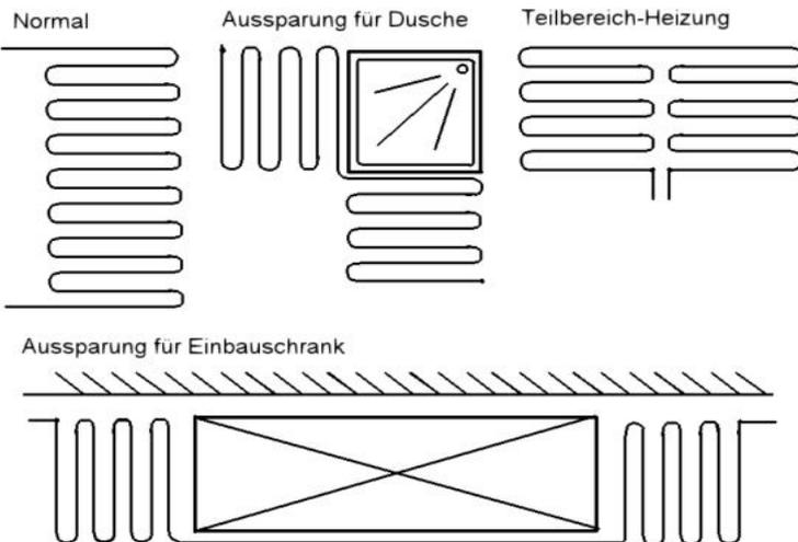
Wird eine Matte in mehreren Bahnen verlegt, muß die Vernetzung an der Schnittstelle vom Heizleiter getrennt werden.
