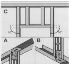
Als Türsturz wird oberhalb der Türöffnung ein beidseitig um 90° abgewinkeltes UW-Profil gemäß Abbildung C an den UA-Profilen befestigt. Die CW-Profile werden über der Türöffnung im bekannten Abstand weitergeführt.
