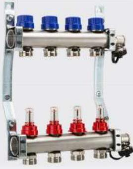
aus **Edelstahl (V2A)** Rundrohr im Vorlauf eingebaute Topmeter zur stufenlosen exakten Einstellung des Durchflusses 0,5 bis 5 l/min, Wandhalter mit Schallschutzgummi Vor-/Rücklaufrohre beiderseits 1" IG Achsabstand 210mm Rücklaufverteiler mit Ventileinsätzen M30x1,5 Abgänge mit 3/4" Eurokonus, e=50mm 2x KFE-Hähne m.Entlüftung 2x Kugelhahn 3/4" blau/rot bis 5 Heizkreise bzw. 2x Kugelhahn 1" blau/rot ab 6 Heizkreise
