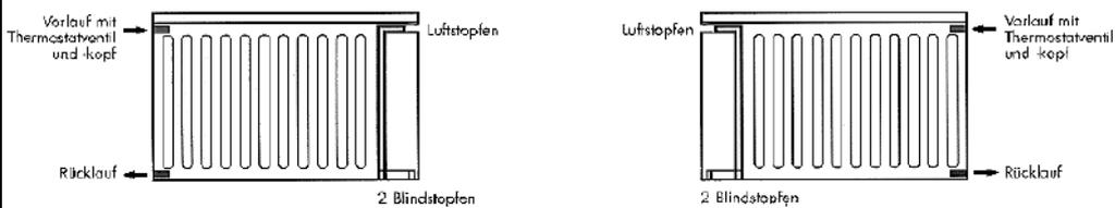
Für Einrohrbetrieb ist grundsätzlich eine Einrohrverschraubung erforderlich.
